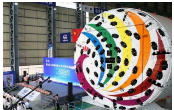
图 24：国内最大直径硬岩掘进机 (TBM) “彩云号”
